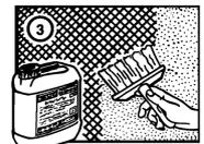
Ohne Wartezeit dann KÖSTER Kellerdicht 3 Härte-Flüssig mit einem sauberen Quast, z. B. dem KÖSTER Quast für Flüssigkeiten aufstreichen.
