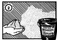
Dann sofort KÖSTER Kellerdicht 2 Blitzpulver trocken in die noch frische, nasse Schlämme mit der Hand fest einreiben bis die Fläche trocken ist.
